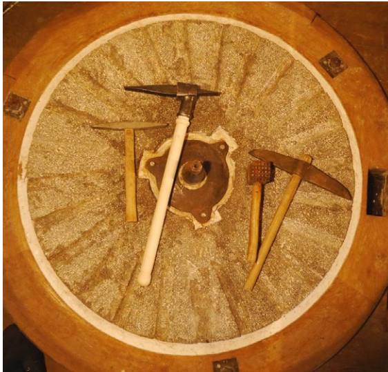
Werkzeuge zum Mühlsteinschärfen von links nach rechts: Bille, Messerbille, Kronhammer, Zweispitz
